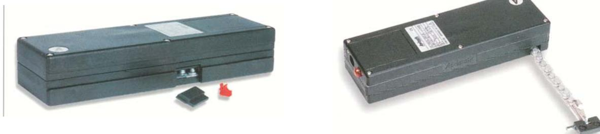
Электромеханический цепной привод, в котором цепь работает в нейлоновом корпусе. Система предназначена для верхнеподвесных и нижнеподвесных окон, регулируемый рабочий ход от 90 до 400 мм. Система оснащена концевым микровыключателем. Световой индикатор подает сигнал о закрытом положении окна. Для защиты от коррозии цепь снабжена нанесенным покрытием из "дакромета", вследствие чего она защищена даже при сложных условиях эксплуатации.
