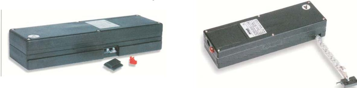
Электромеханический цепной привод, в котором цепь работает в нейлоновом корпусе. Система предназначена для верхнеподвесных и нижнеподвесных окон, регулируемый рабочий ход от 90 до 400 мм. Система оснащена концевым микровыключателем. Световой индикатор подает сигнал о закрытом положении окна. Для защиты от коррозии цепь снабжена нанесенным покрытием из "дакромета", вследствие чего она защищена даже при сложных условиях эксплуатации.
