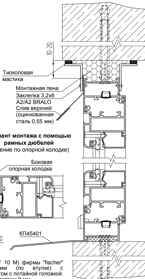
Вариант монтажа с помощью рамных дюбелей
