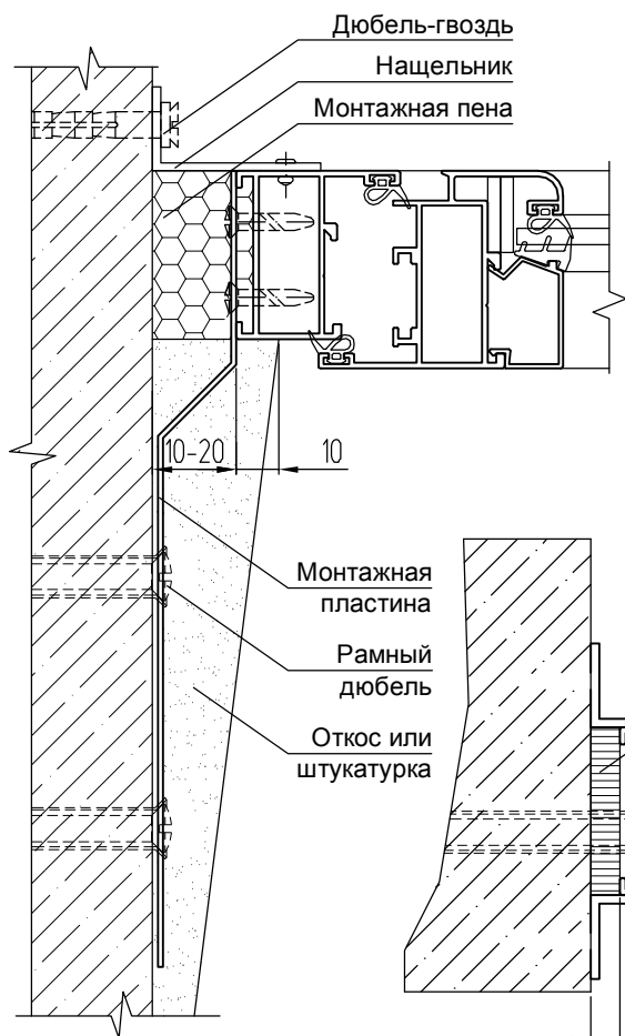
Вариант монтажа с помощью рамных дюбелей (сечение по опорной колодке)
