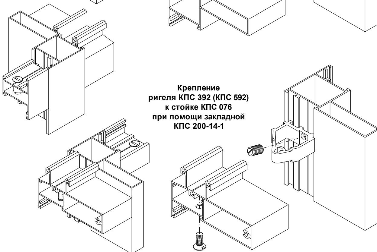
Усиленное крепление ригеля КПС 392 при помощи закладной КПС 200-14-1 и винта 4,8x32 DIN 7981
