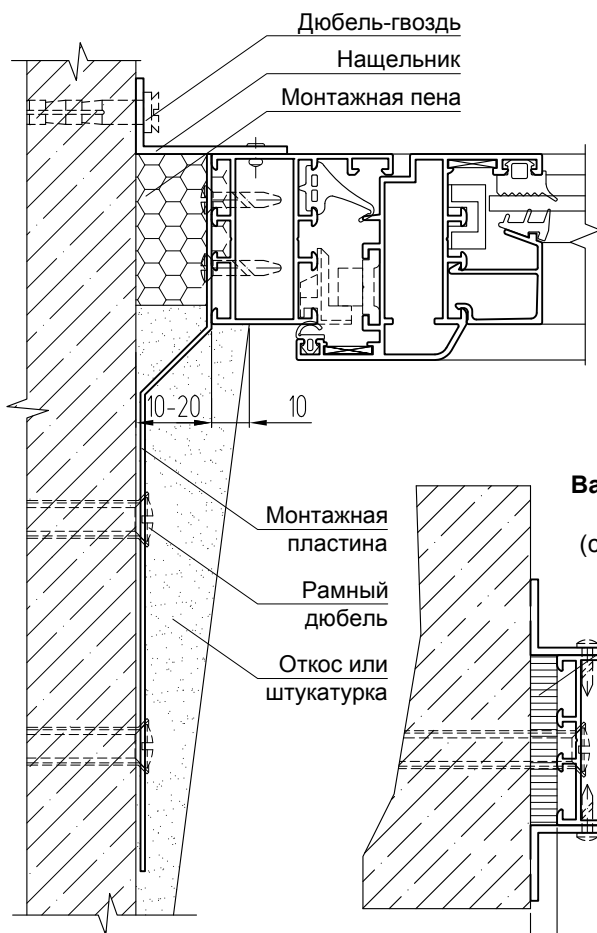
Вариант монтажа с помощью монтажных пластин
