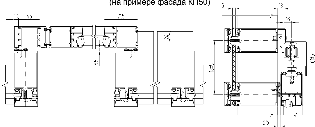
Установка привода автоматического открывания створки FAAC 930N SF2
